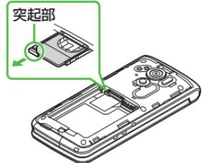
**③ USIMカードを少し持ち上げながらスライドして取り外す**
